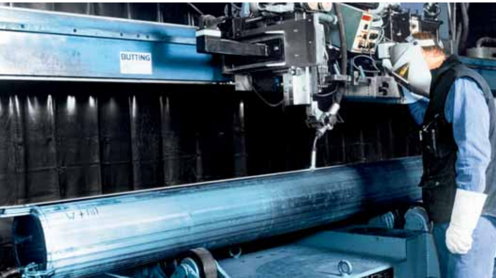
Herstellung einer Ofenrolle aus Nicrofer® 6025HT/ alloy 602CA mit CRONIGON® Ni30. (Quelle: H. BUTTING GmbH & Co. KG)
